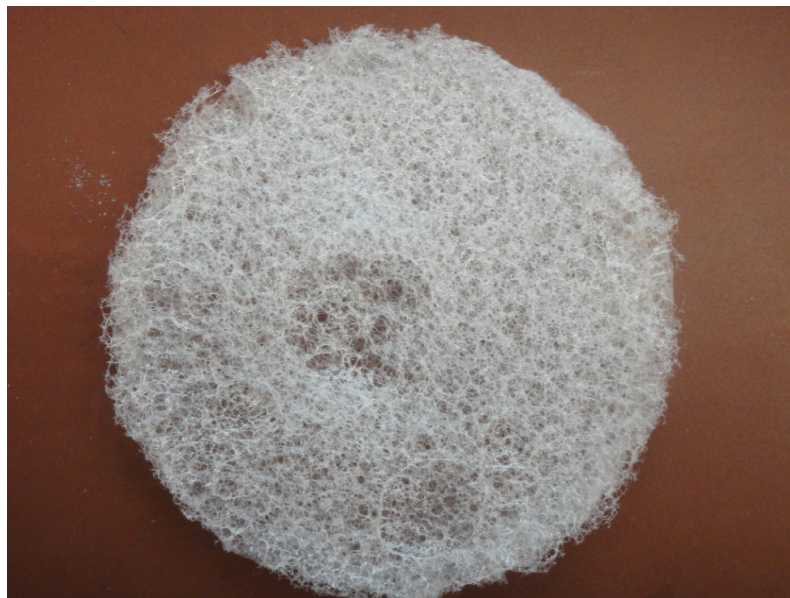
Abb 2.: Gelatineschaumfolie aus mit Duschgel aufgeschüttelter Gelatinelösung
