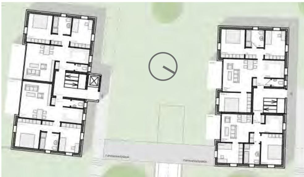
Abbildung 6-3: MFH KON - Grundrissdarstellung der Häuser 1 und 2
