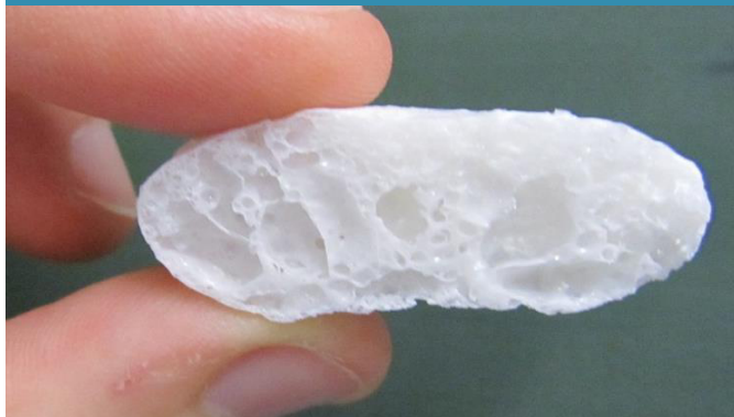
Im SchülerInnenversuch expandiertes Polystyrol (Styropor®) Wärmeleitfähigkeit 0.03-0.04 W·m -1 ·K -1
