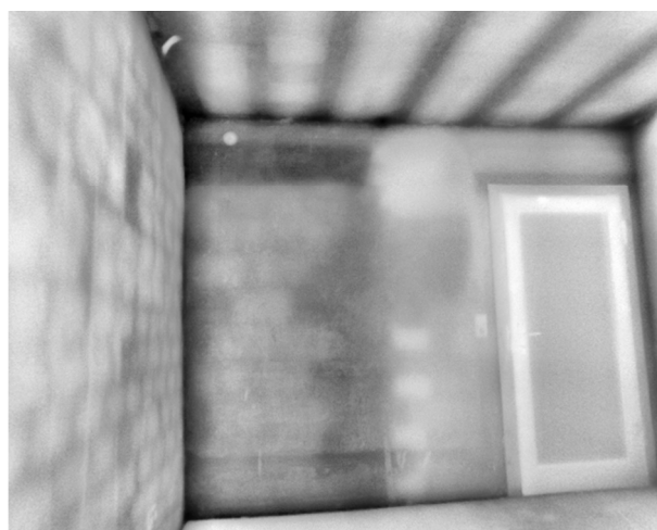
Abbildung 52 Nachträglich vermauerte Bereiche in Wänden: Links: Thermographie mit niedriger Auflösung; Rechts Thermographie mit hoher Auflösung
