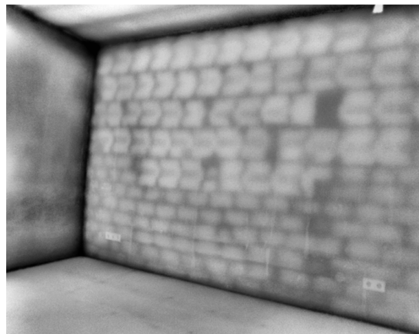
Abbildung 51 Wand aus unterschiedlichen Materialien: Links: Thermographie mit niedriger Auflösung; Rechts Thermographie mit hoher Auflösung
