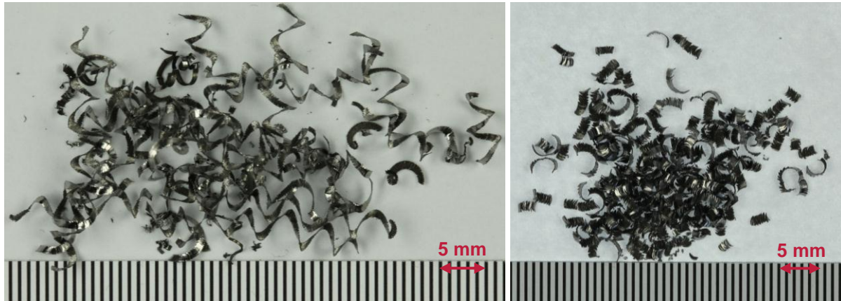
Abbildung 49: Aufnahmen der Späne der Legierungen Ti 6Al 4V 0,9La 0,25Fe (links) und Ti 6Al 7Nb 0,9La 0,25Fe (rechts). Zerspant wurde mit einer neuen Hartmetallschneidplatte mit einer Schnittgeschwindigkeit von 60 m/min, einer Schnitttiefe von 0,5 mm und einem Vorschub von 0,1 mm.
