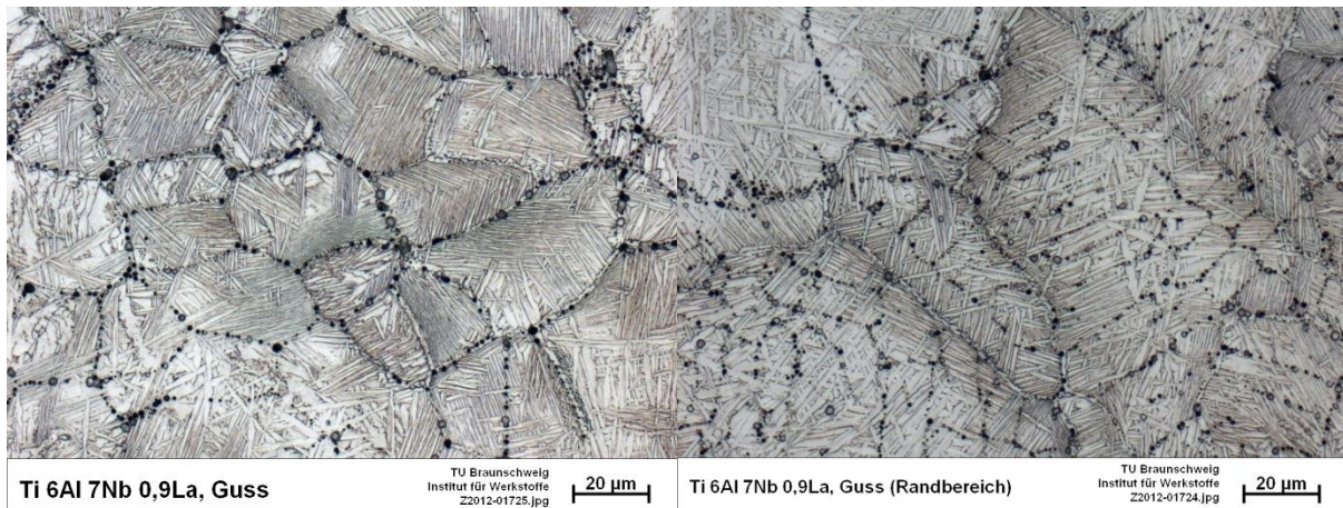
Abbildung 37: Gefügebilder von Ti 6Al 7Nb 0,9La im Gusszustand in der Probenmitte (links) und am Rand (rechts).
