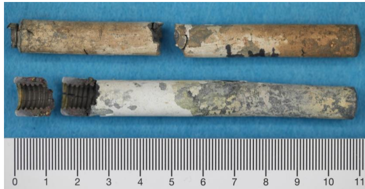
Abbildung 18: Proben der Legierung Ti-FM, die beim Rundkneten versagten. Probe FM 9 (oben) brach in der Mitte und Probe FM 12 (unten) am Gewinde. Die Umformung war unvollständig und die Proben konnten somit nicht weiter verwendet werden.
