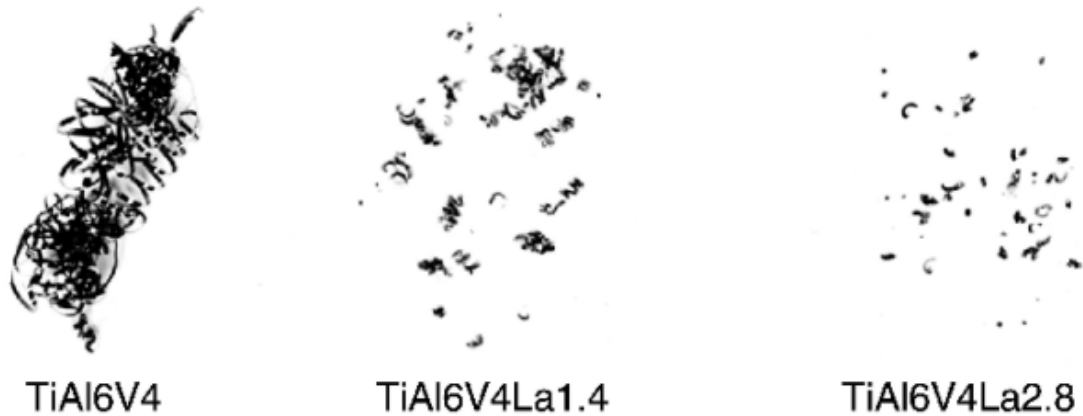
Abbildung 1: Die Länge der Späne sinkt mit steigendem Lanthangehalt im Gefüge.
