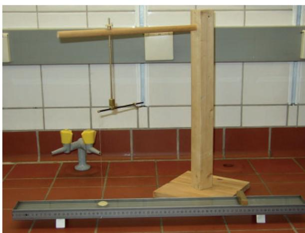
**Abb. 2:** Die Schieberinne, die Agnes Pockels für ihre Messungen 1881 entwickelte (Nachbau der mechanischen Werkstatt der TU Braunschweig) Foto: Agnes-Pockels-Labor
