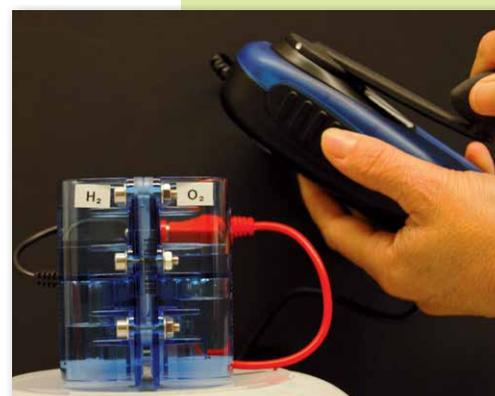
Abb. 9: Wasserelektrolyse mit einem Handgenerator
