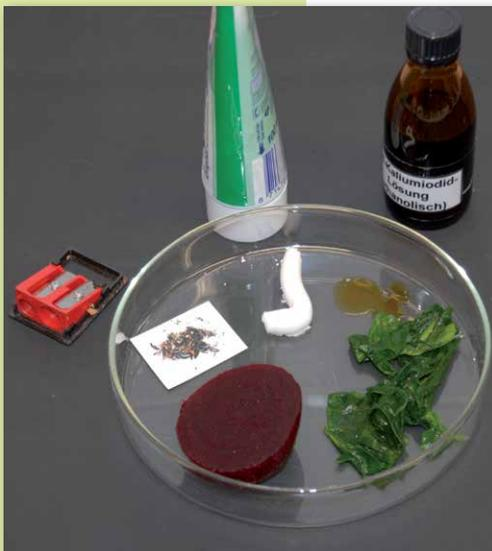
Abb. 7: Materialien für den Bau einer Grätzelzelle
