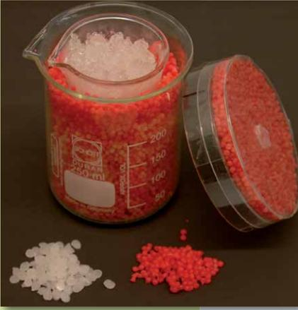
Abb. 14: Paraffinpellets, in Alginat mikroverkapseltes Paraffin und Thermobecher
