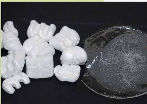
Abb. 15: Polystyrolverpackungschips und daraus hergestellte Folie
