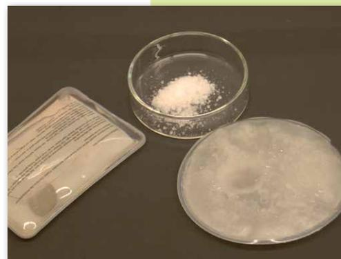
Abb. 3: Latentwärmespeicher in Taschenformat mit Natriumacetat-Trihydrat
