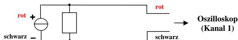
Abb. 4: Schaltskizze zur Strommessung
