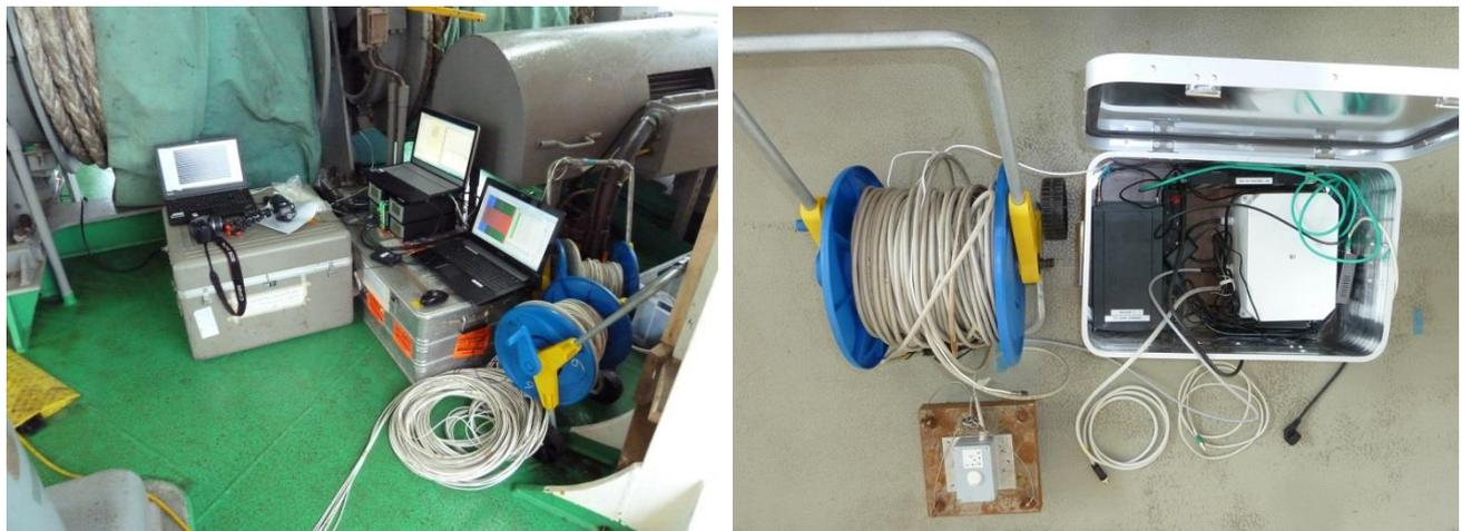
Abbildung 31: zentrale Messwerterfassung an Deck des Errichterschiffes (links) und Messequipment an den einzelnen Messloktionen (rechts)
