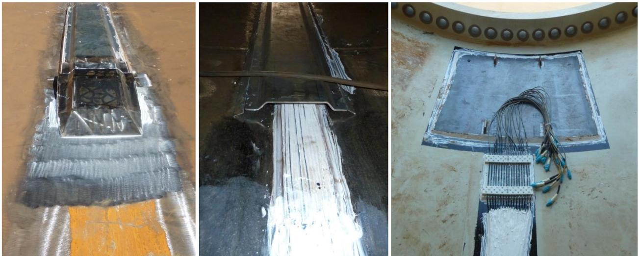
Abbildung 25: geklebter Rammschuh (links), Schutzprofil und Kabelstrang (Mitte), Zugentlastung und Aufhängung für die Datenerfassung (rechts)
