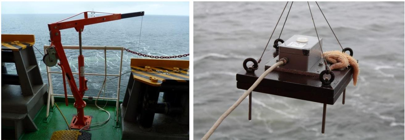
Abbildung 30: Krane zum Ablassen der Geophone (links) und Geophon nach der Bergung (rechts)
