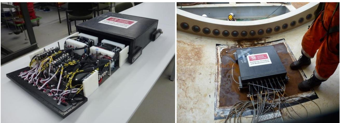
Abbildung 26: autarke Messwerterfassungseinheit im Labor des IGB-TUBS (links) und im Pfahl kurz vor der Rammung (rechts)
