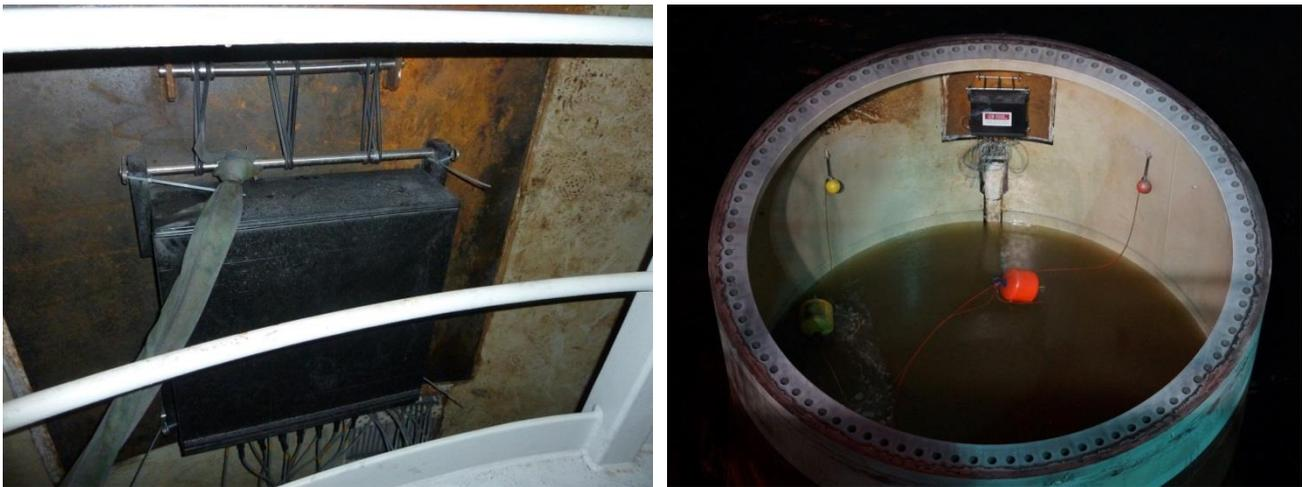
Abbildung 36: Bergung der Messbox im Pfahl A22 (links) sowie Messbox nach Rammung an Pfahl A66 (rechts)
