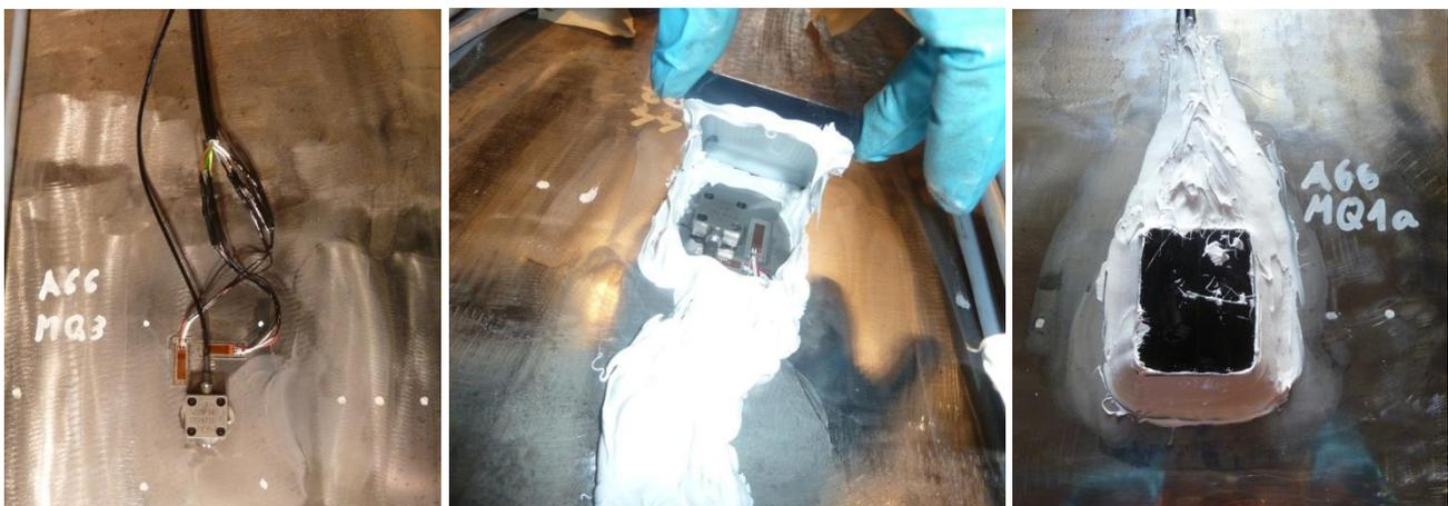
**Abbildung 24: Applizierte Dehnungs- und Beschleunigungssensoren (links), Einhausung der Sensoren (Mitte), und fertig gekapselte Messstelle (rechts)**
