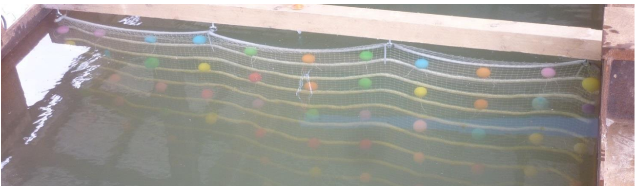
Abbildung 27: HSD-Netz mit Latex-Ballons unter Wasser im Stahltrog
