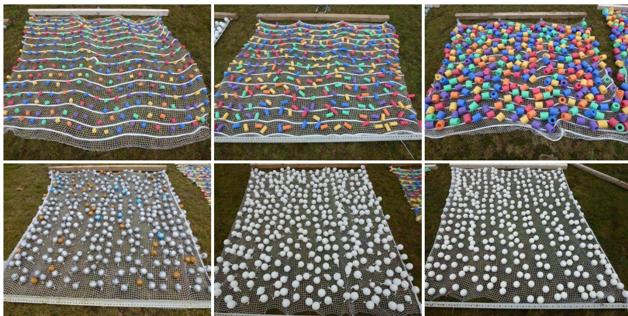
Abbildung 28: im Stahlrog untersuchte HSD-Netze mit kleinen kurzen Nudeln (oben links), kleinen langen Nudeln (oben mittig), großen Nudeln mit Loch (oben rechts), alten Latex-Ballons (unten links), neuen Latex-Ballons (unten mittig) und Schaumstoffbällen (unten rechts)
