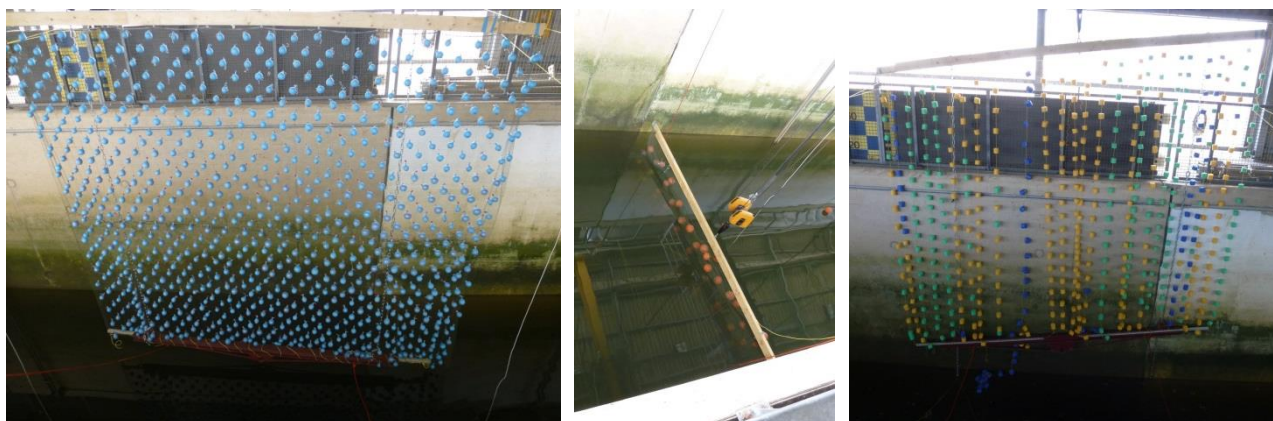
Abbildung 30: im GWK untersuchte Netze mit Latex-Ballons (links), mit Ballblasen (unter Wasser, Mitte) sowie mit Schwimmdudeln (rechts)
