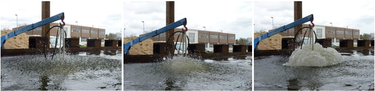
Abbildung 25: Schuss der Airgun zur Auslösung eines Hydroschall-Impulses im Stahltrog des IGB-TUBS
