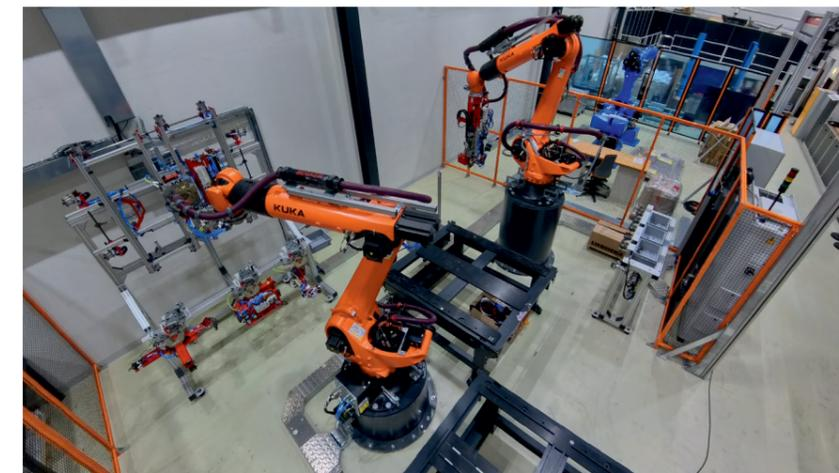
Prototypische Anlage zur automatisierten Demontage von MEB-Batteriesystemen mit einem Demontagetisch zwischen den Industrierobotern, einem Ablagetisch für demontierte Batteriemodule sowie verschiedenen Aufbewahrungsbehältern für eine systematische Sortierung demontierter Bauteile am Standort Wolfsburg
