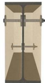
Hybridbauteil aus Stahlprofilen und leistungsstarken Holzquerschnitten
