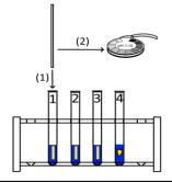
**Tauche** einen Glasstab in RG 1 ein und gib damit einen Tropfen Flüssigkeit auf kleines Stück pH-Papier. Vergleiche die Farbe des pH-Papiers mit der pH-Farbskala.
