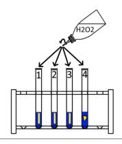
Gib dann einen Spritzer Wasserstoffperoxid-Lösung in jedes RG und schüttle leicht.
