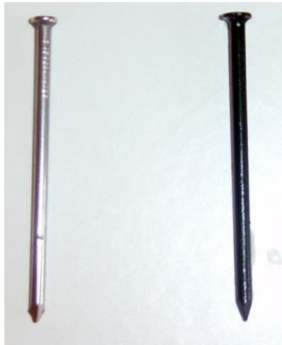
Abb. 1: Rechts: Eisennagel, der zwei Tage in einem Cola-Getränk aufbewahrt wurde.
