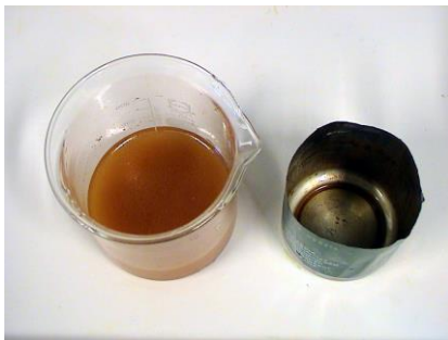
Abb.1: Rostbildung an der Bodenhälfte einer Getränkedose nach 1-2 Tagen Korrosion
