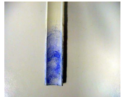
Abb.3: Der weiße Feststoff enthält Aluminium (Bildung von Thénards Blau).
