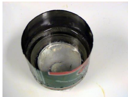
Abb.2: Bei der Korrosion der Deckelhälfte ist keine Rostbildung zu erkennen; vielmehr entsteht ein weißer Feststoff direkt am Deckel.
