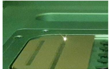
Oberflächliches SLM auf CuCr1Zr-Blech
