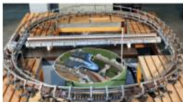
Entwicklung eines 3D-Linearmotors mit Versuchsanlage. TU Braunschweig - IMAB
