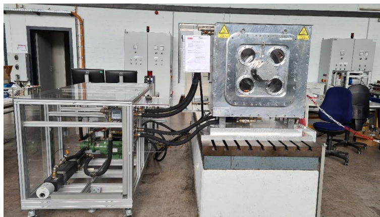
Messprüfstand für Kühlsysteme elektrischer Maschinen in den IMAB Laboren
