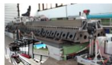
Hochleistungs-Linearantrieb mit besonders hoher Kraftdichte für Fahrsimulator
