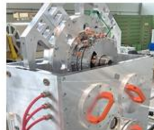
Prüfstand zur Durchführung von Kühlungsuntersuchungen an E-Maschinen
