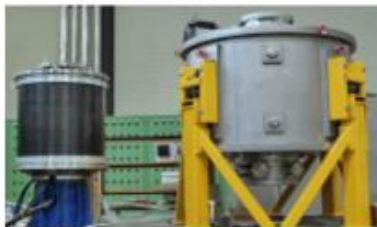
Superleitend gelagerter Schwunngmassen-energiespeicher (DynaStore), 2 MW Schwungrad mit HTSL-Lager 10.000 U/min. TU Braunschweig - IMAB
