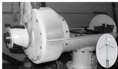
Spark-Generator für moderne Windkraftanlagen 15 kW mit Axialfeld-Synchronmaschine. TU Braunschweig - (IEM) IMAB
