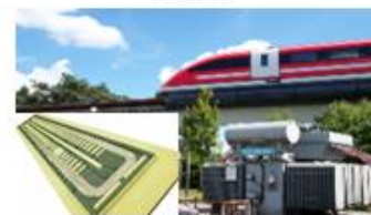
Erprobung TR09; Induktive Batterie-ladung; Transrapid (P=500 kW) (Versuchsanlage Transrapid)77
