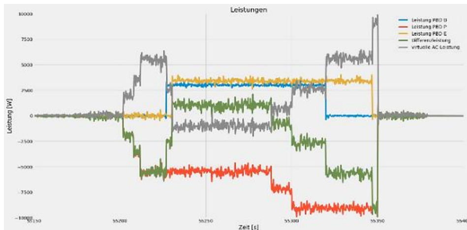
Test von unterschiedlichen Leistungsflüssen inklusive Lastsprüngen
