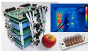
Leistungselektronische Wandler mit Schnellschaltenden Halbleitern 100 kW, 100 kHz
