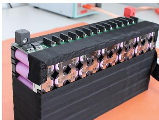
Batteriepaket mit aufgesetzter BMS-Platine und fast vollständiger Ummantelung
