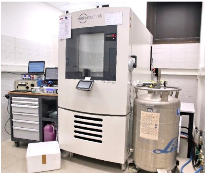
Klimaschränk (Konfiguration: Untersuchungen von Halbleitern in sehr tiefen Temperaturen)
