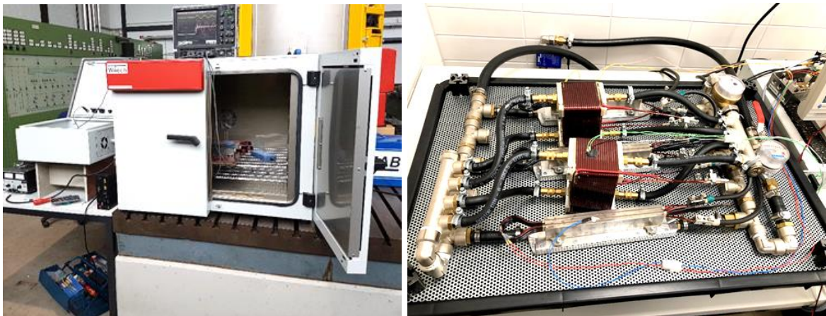
Alterungsprüfstände zur thermisch-elektrischen-Belastung (links) und zur Belastung mit Temperaturzyklen (rechts)
