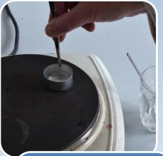
Gib einen Teelöffel der Lösung in die Teelichtschale und stelle sie mit der Pinzette auf die heiße Herdplatte.
