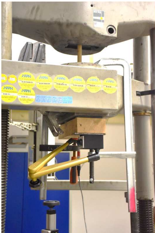
a) Abbildung 1-6 Test-setup der Zugprüfung TV2 a) Bild b) Wegmesser zwischen Bauteiloberfläche und Dolle für die Messung der lokalen Verschiebung der HKD c) Schema.
