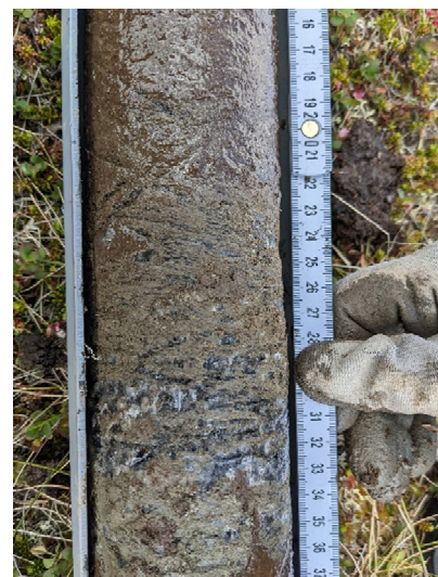
Abbildung: Links: Konventioneller Probenhalter mit Anordnung der Elektroden (A,B,M,N). Mitte: Entnahme eines Eisbohrkernes. Rechts: gefrorene Bodenprobe mit sichtbaren Eisschichten.
