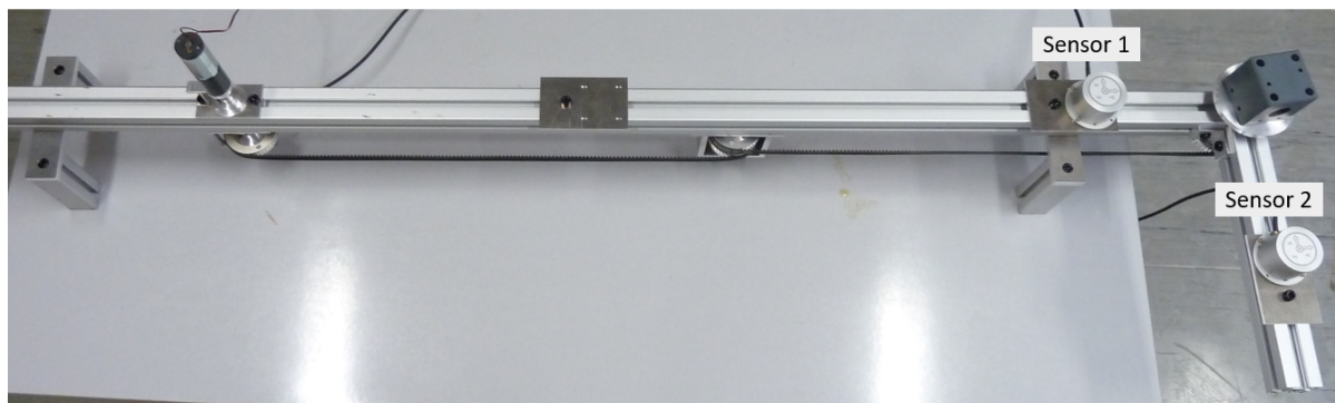
Abbildung 3.1.: Versuchsaufbau. Die Position des ersten Sensors auf der langen Schiene wird während des Versuchs variiert. Der zweite Sensor bleibt nach Positionierung auf der kurzen Schiene unbewegt.
