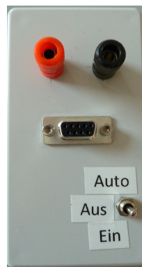
Abbildung 3.3.: Aufsicht der Motorsteuerungseinheit. Die Kabel des Motors werden in die oberen beiden Anschlüsse gesteckt. Eine Verpolung der Kabel ändert die Drehrichtung des Motors. Für die Steuerung über das LabView-Programm muss der Schalter in der oberen Position, also auf Auto , stehen. Steht der Schalter auf Ein , läuft der Motor dauerhaft. Eine Steuerung über den Computer ist dann nicht möglich.
