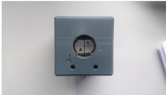
Abbildung 3.4.: Probenhalter mit eingebauter Probe. Die Probe ist in der Halterung entsprechend auszurichten um den Messaufbau zu vereinheitlichen und Messergebnisse vergleichbar zu machen.
