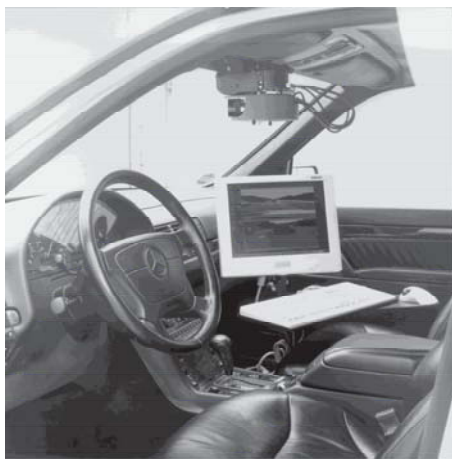
Abbildung 7.5: Multifokale Kameraanordnung für die Vorausschau in VaMP (Einbau und Seitenansicht); seit 1999
