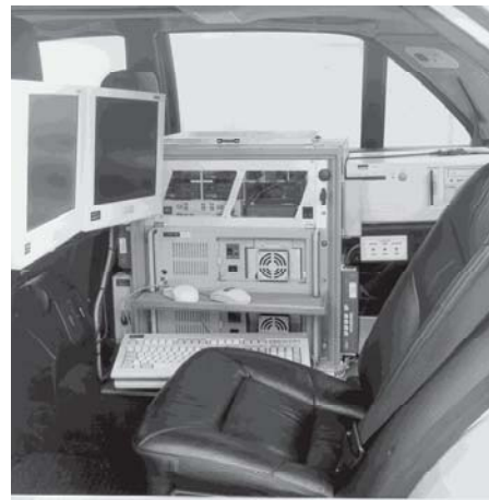
Abbildung 7.9: Zusätzliches Rechnerregal auf der Rückbank von VaMP
