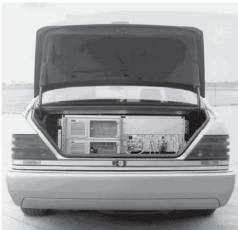
Abbildung 7.8: Rechnerausrüstung im Kofferraum von VaMP
