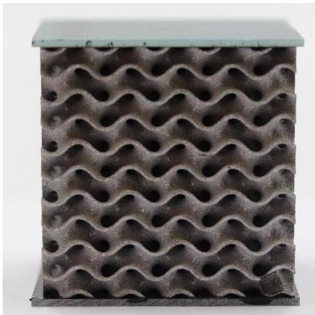
In einem Teilprojekt des Exzellenzclusters SE<sup>2</sup>A – *Sustainable and Energy-Efficient Aviation* – soll eine neuartige Flügelvorderkante mit einer Sandwich-Struktur aus einer zellulären Struktur entworfen werden. Diese Flügelvorderkante muss unter anderem gegen Vogelschlag ausgelegt werden.
