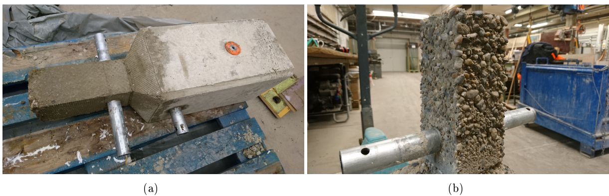
Abbildung B.7: (a) Verjüngter Fußbereich des Stützenstumpfes vor (b) und nach dem Entfernen der verzögerten Betonoberfläche
