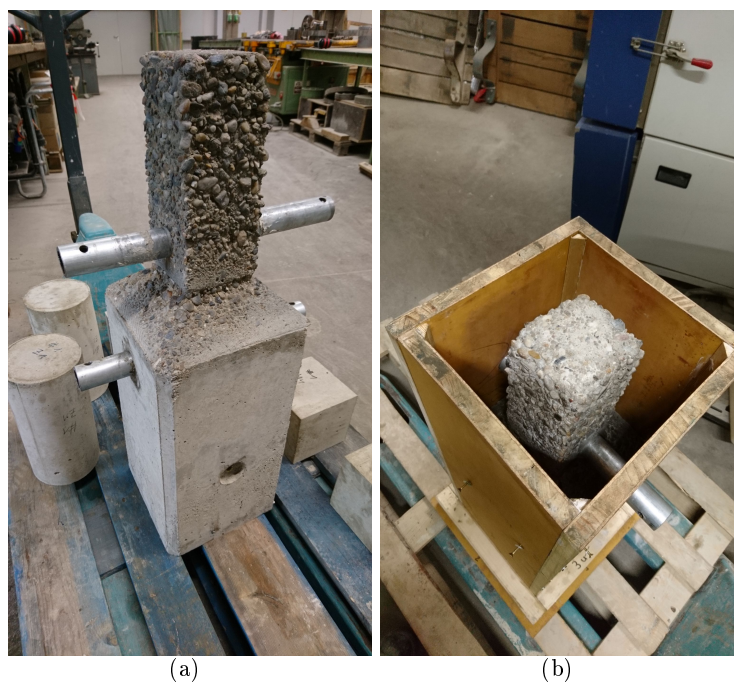
Abbildung B.9: (a) Probekörper vorbereitet für die Betonage des Betonersatzes (b) Probekörper eingeschalt vor der Betonage
