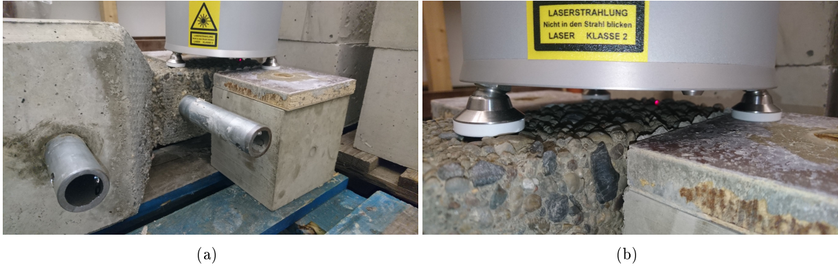
Abbildung B.8: (a) Rautiefemessung mit dem ELAtextur Gerät (b) Detailaufnahme mit sichtbarem Laser
