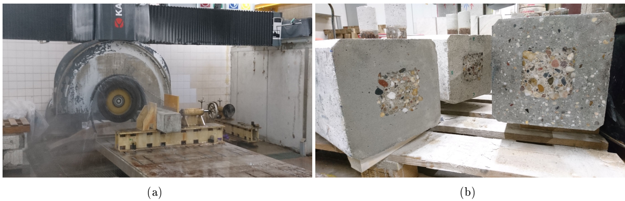
Abbildung B.12: (a) Schleifarbeiten an einem der Probekörper (b) Geschliffene Unterseite aller drei Verbundprobekörper
