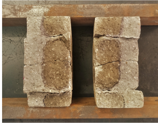
Abbildung 20: Eindringfront der chloridhaltigen Prüflösung (hellgrau) in einen bei 80 % Last geprüften und danach gespaltenen RM.3 Probekörper. Die Eindringfront zeigt deutlich zwei Hauptrisse in den Viertelspunkten des Querschnitts, die zu einer Wegigkeit des Chlorids geführt haben.
