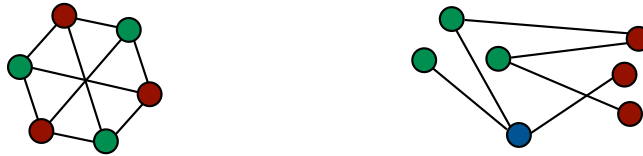
Abbildung 1.22: Beispiele für einen 2-partiten und einen 3-partiten Graphen, wobei der erste auch vollständig bipartit ist und in der Literatur K_{3,3} genannt wird.
