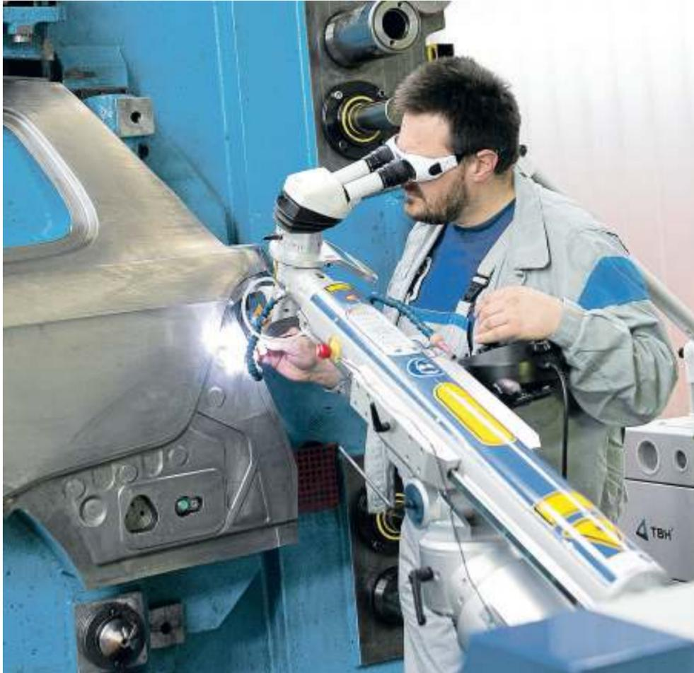
Ein VW-Mitarbeiter setzt im Werk Emden mit einem Laser-Schweiß-Roboter ein Press-Werkzeug instand.
