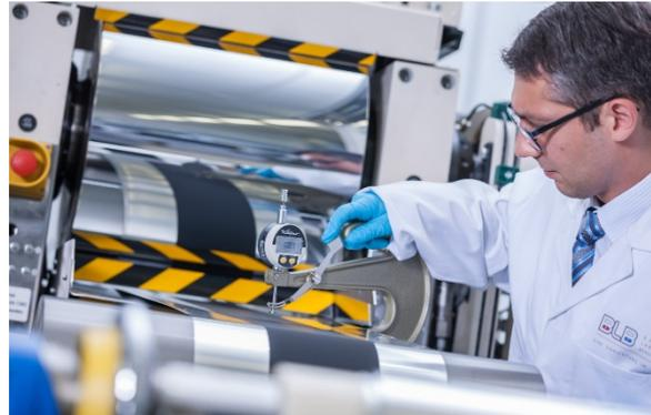
*Ein Mitarbeiter der Battery LabFactory Braunschweig (BLB) prüft die Verdichtung einer Kathode – eine wesentliche Komponente einer Batteriezelle.
